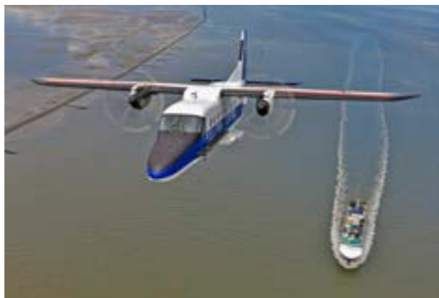
Seitlich an der Do 228 ist das SLAR angebracht (schwarz), das die Wasseroberfläche bis zu 40 km zu jeder Seite auf Veränderungen absucht
