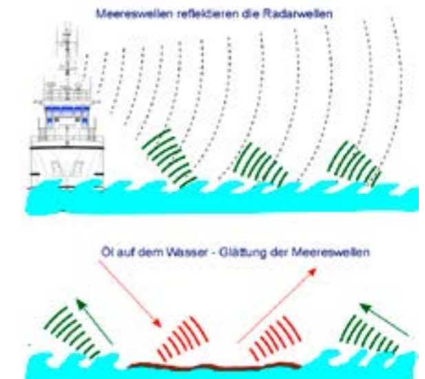
Prinzip der Ölerkennung auf der Wasseroberfläche
